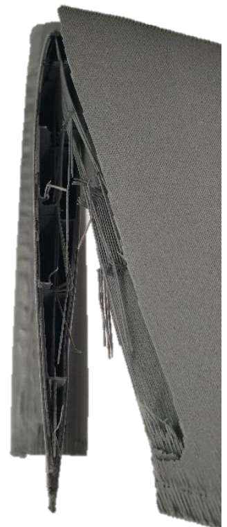
Abbildung 34: 3D-gedruckter Canard-Flügel nach Belastungstest
