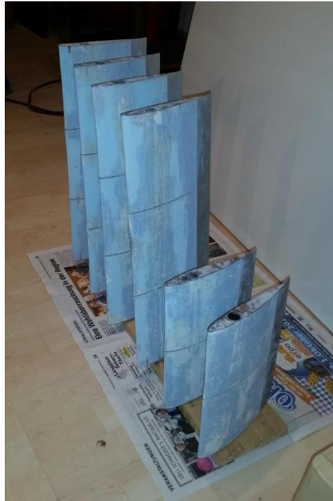
Abbildung 39: Foils beim Trocknen nach dem Spachteln
