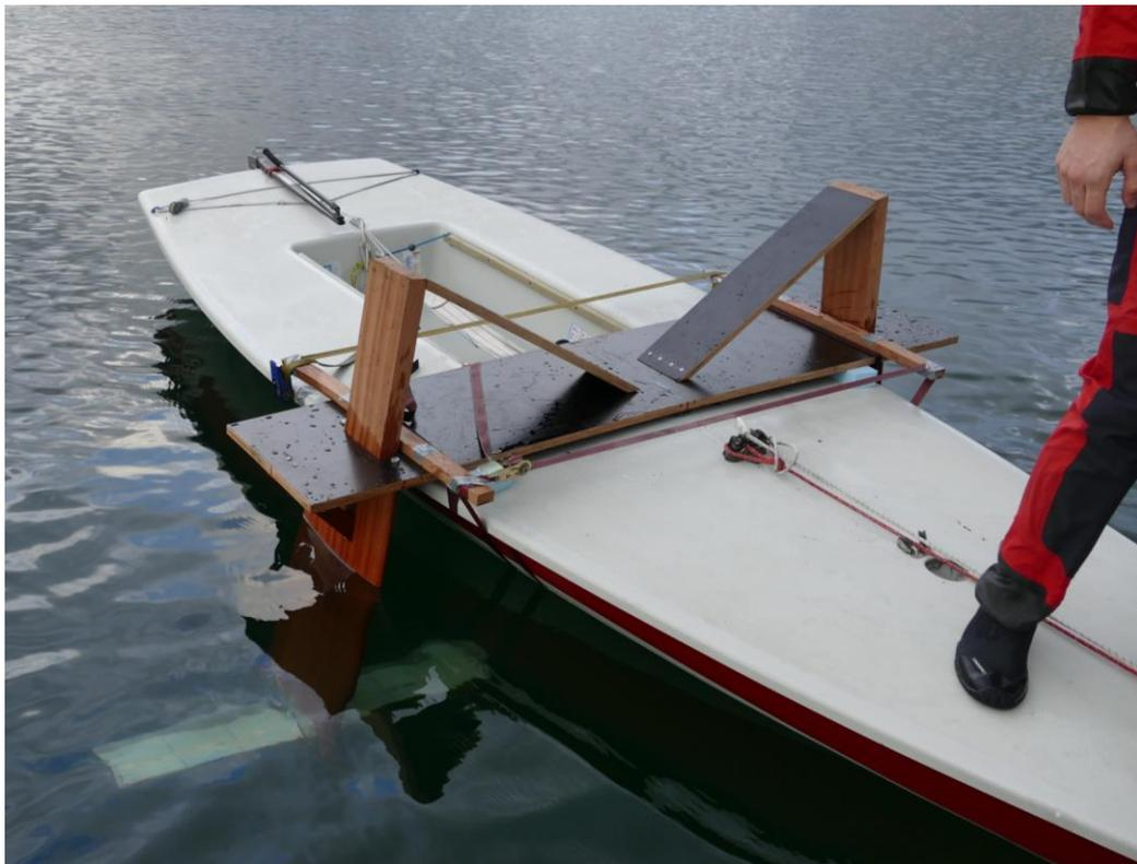
Abbildung 49: Befestigter Hauptfoil beim ersten Testlauf
