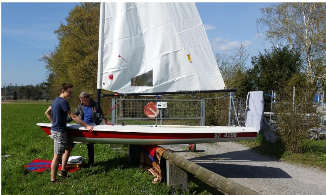
Abbildung 26: Schwerpunktbestimmung des Laser
