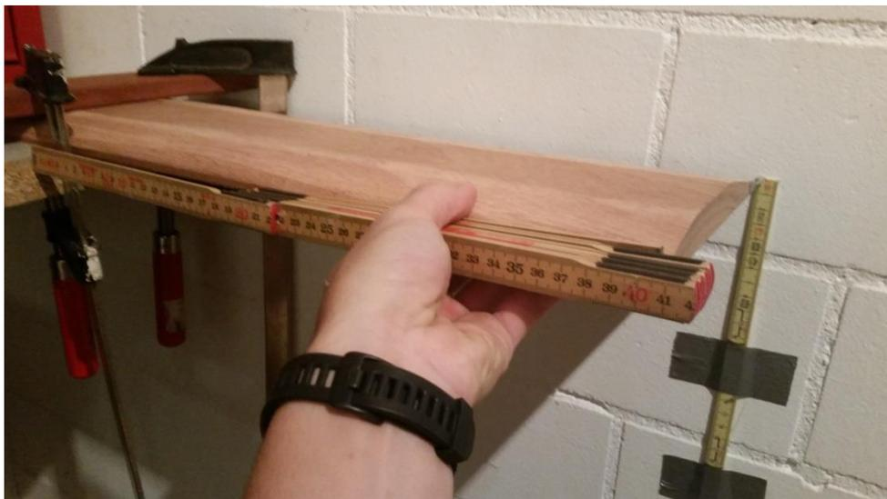
Abbildung 23: Versuchsaufbau des Belastungstests eines Holzflügels
