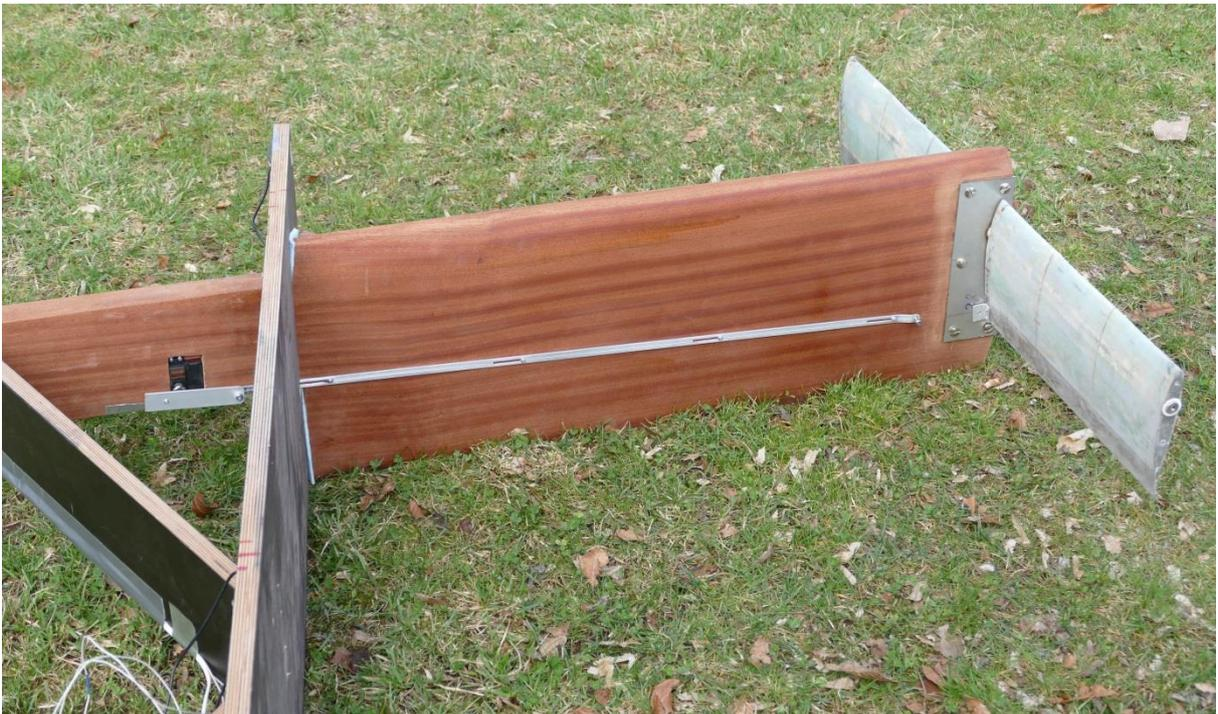
Abbildung 46: Mechanik des Hydrofoils
