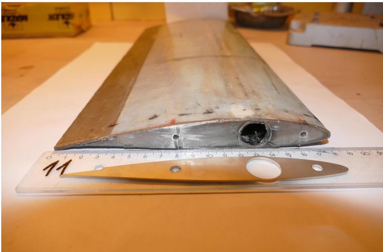
Abbildung 42: Hauptfoilsektion und Flügelrippe (Massstab für das Grössenverhältnis)
