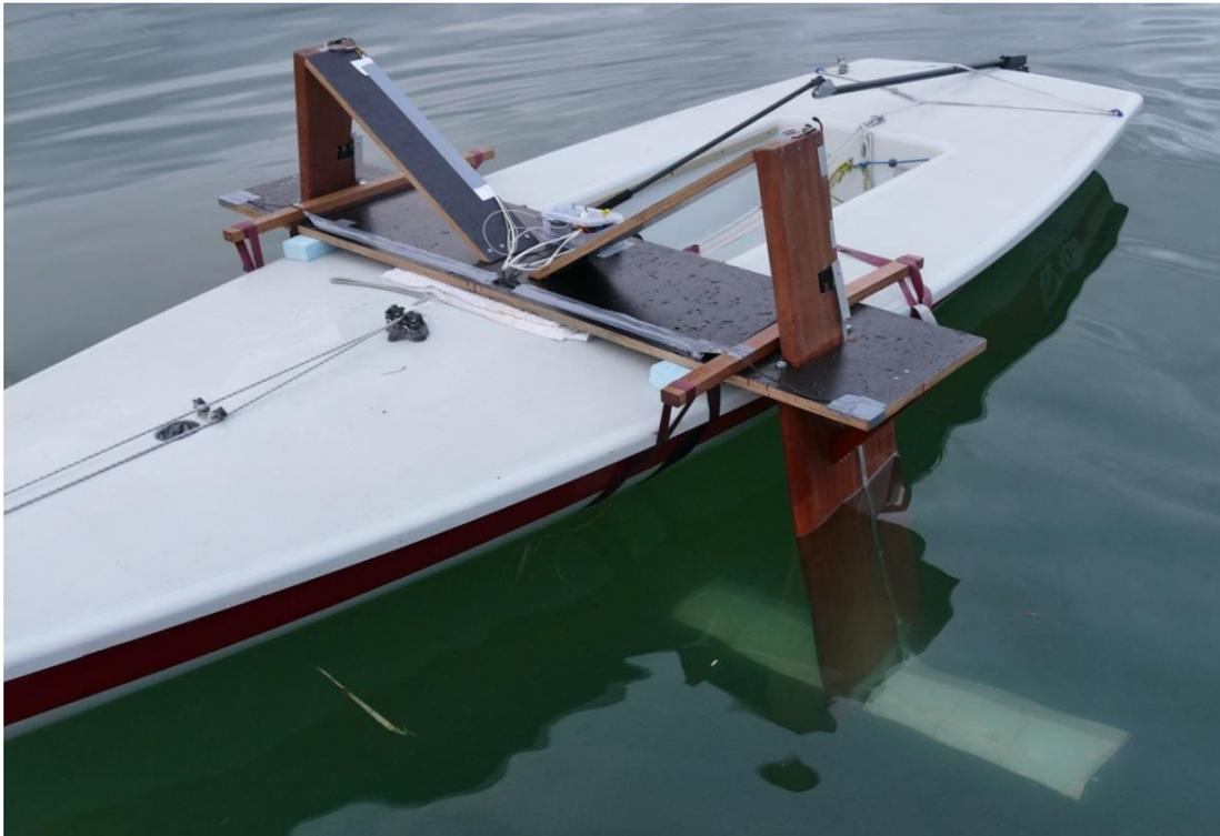
Abbildung 54: Befestigter Hydrofoil beim zweiten Testlauf
